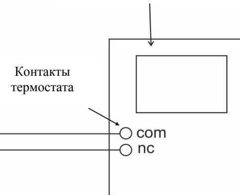
Подключение комнатного термостата имеющего гнезда COM, NC, NO.
