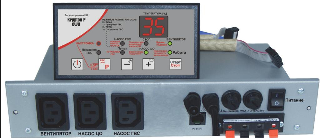
Микропроцессорный регулятор температуры котла центрального отопления (ц.о.) предназначен для управления работой котла ц.о. с воздуходувкой; стабилизирует его температуру с помощью плавной регулировки оборотов воздуходувки, производит продувку котла (с целью ликвидации накопленных газов, образовавшихся в результате процесса горения) и защищает систему центрального отопления от закипания воды. Регулятор управляет также работой насоса центрального отопления и насоса ГВС.
