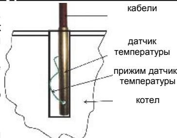
Датчик температуры можно прикрепить на неприкрытой выходной трубе котла ц.о., используя шплинтовое крепление (бандаж). После предварительной затяжки бандажа – как показано на рисунке (бандаж можно обернуть вокруг трубы два раза, или отрезать излишек ножницами для металла), вложить датчик температуры между бандажом и трубой.
