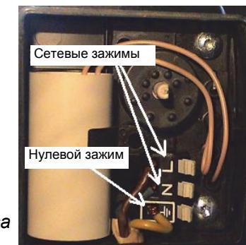
Рис. Подсоединение проводов от вентилятора/насоса к вилке
