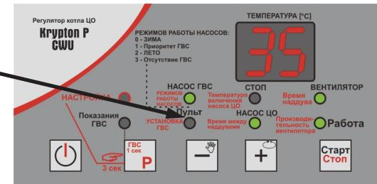
Циркуляционный насос работает еще в течение 30 секунд от момента, когда произошло замыкание контактов термостата, затем циклически включается на 30 секунд через каждые 5 минут. Если температура котла будет выше 80°C, Регулятор включит насос, несмотря на показания комнатного термостата.
