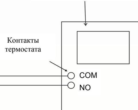
Подключение комнатного термостата имеющего только гнезда COM и NO.
